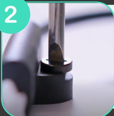
Vissez le port USB-C sur l'appareil grâce au petit tournevis fourni dans la boîte
