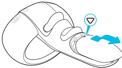
2. Insérez 2 piles alcalines AAA/LR03 dans le compartiment. Assurez-vous que les extrémités positives et négatives sont dans la bonne direction.
