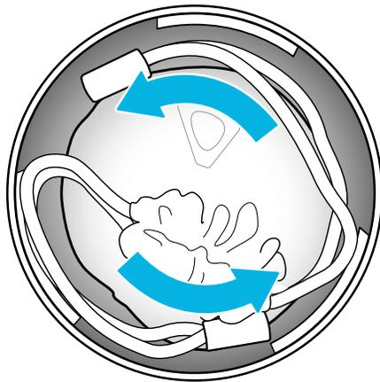
6. Enroulez le câble USB-C à USB-C et placez-le à l'intérieur du capuchon de manière à ce qu'il s'insère bien derrière les encoches.
